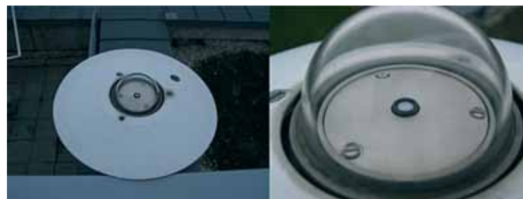
Bild 10: Diffusorkonfiguration zur Aufnahme von Tageslichtspektren
